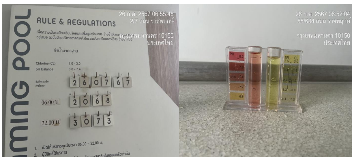
ภาพที่ 4.5-1 การตรวจวัด pH และ Free Chlorine สระว่ายน้ำ
